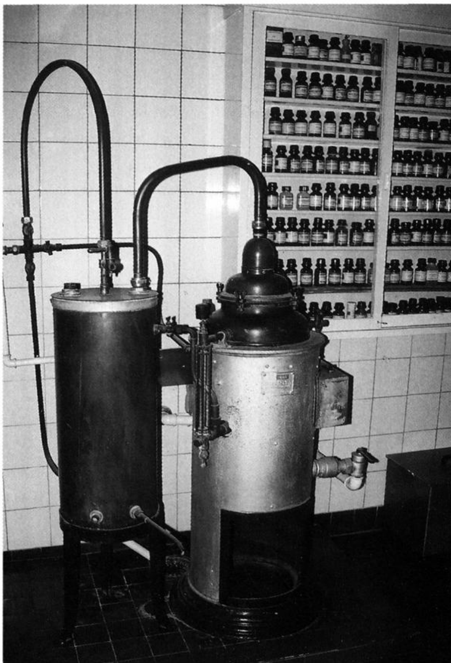
Abb. 14: Destilliergerät von 1948 (Firma Franz Hering, Apparatebauanstalt in Jena).
