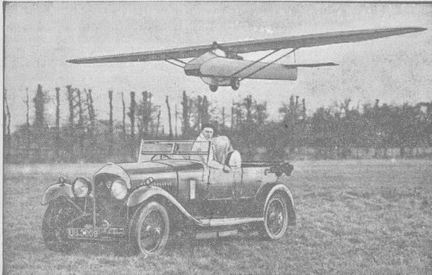
(Das Gleitflugzeug über dem Auto.) Das schwierige Problem des Segelflugzeug-Starts scheint durch eine neuartige Abflugmethode eine einfache Lösung gefunden zu haben. Auf dem Hanworth-Flugplatz in England wurden Versuche mit einem fahrenden Auto gemacht, das das Gleitflugzeug ins Schlepptau genommen hatte; der Abflug ging mühelos vonstatten.
