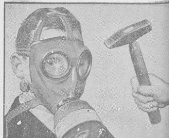
In den Auer-Werten in Drammenburg werden die dort hergestellten Gasmasten auf die Splitterfestigkeit des Augenglasses geprüft. Bei einem kräftigen Hammer Schlag springen zwar die Glasstücke, doch bleibt die Maske dicht und die Augen sind nicht gefährdet.
