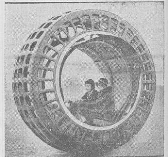
Ein Riefenautorad, das von einem 2,5-PS-Motor getrieben wird und zwei Personen befördern kann, wird jetzt in England auf sein Verkehrsfähigkeit erprobt. Das seltsame Gefährt gleicht einem riesigen Räder mit Motor.
