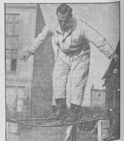
Die fertigen Stier werden einer Belastungsprobe ausgesetzt, um dadurch noch Fehler im Holz festzustellen oder die Biegung zu korrigieren.
