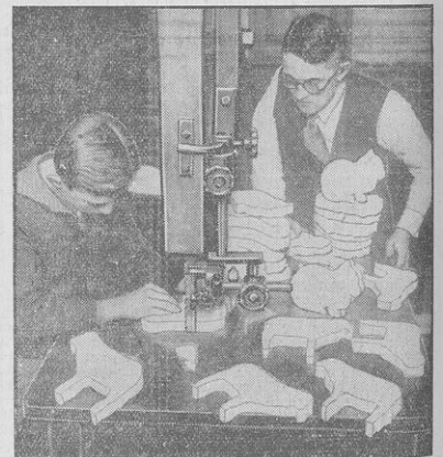
Die erste Station der Holztiere. Mit einer Sägemaschine werden sie zuerst in der Rohform geschnitten.
