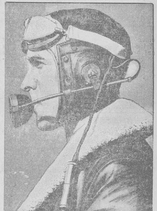
Ein neues Radiotelefon für Piloten wurde von einem amerikanischen Flieger erfunden. Der Pilot trägt einen kombinierten Sender- und Empfangsapparat dauernd um den Kopf, so daß er beide Hände frei hat und gleichzeitig ununterbrochen mit der Funktion in Verbindung bleibt.
