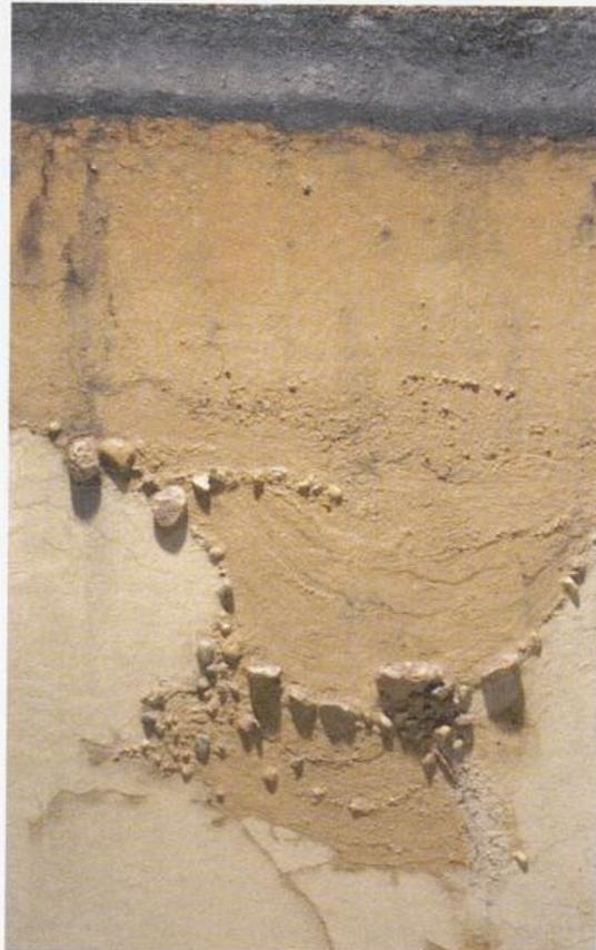
Abb. 5: Ein wiederholtes Gefrieren und Auftauen des Bodens führte zu Materialverschiebungen und Umlagerungen, wodurch das obere Material in das unterlagernde eingearbeitet wurde. Lackprofil aus der Sammlung des LMNM (Inventarnummer L-GEO-13) (Foto: W. Kehmeier)
