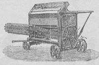
**Breitdresch-Maschinen,** neuester Konstruktion, stabil und fahrbar, in verschiedenen Größen, mit und ohne Wollschüttler. Zum Betriebe genügen 2 leichte Pferde.
