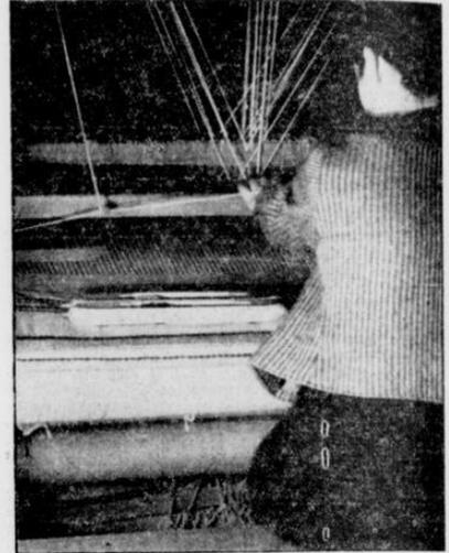
Die „Lade“ wird zurückgeschoben, das Schiffchen mit dem Schußfaden liegt durch das Fach
