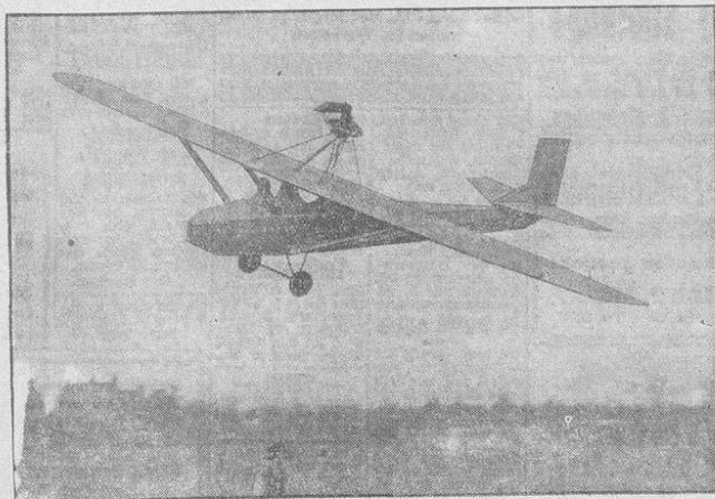
Zu Festham bei London wurde jetzt ein neues Leichtflugzeug vorgeführt, das von einem Motor von nur 6-PS-Leistung angetrieben wird. Die Einfachheit der maßstabes- treuen Ausrichtung, die etwa der eines schweren Motors entspricht, er- möglicht es, dieses Flugzeug zu dem Preis von 1400 RM herzustellen.
