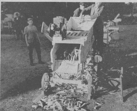
Das Entlickehen der Hüllhäute von den Kolben auf maschinellem Wege
