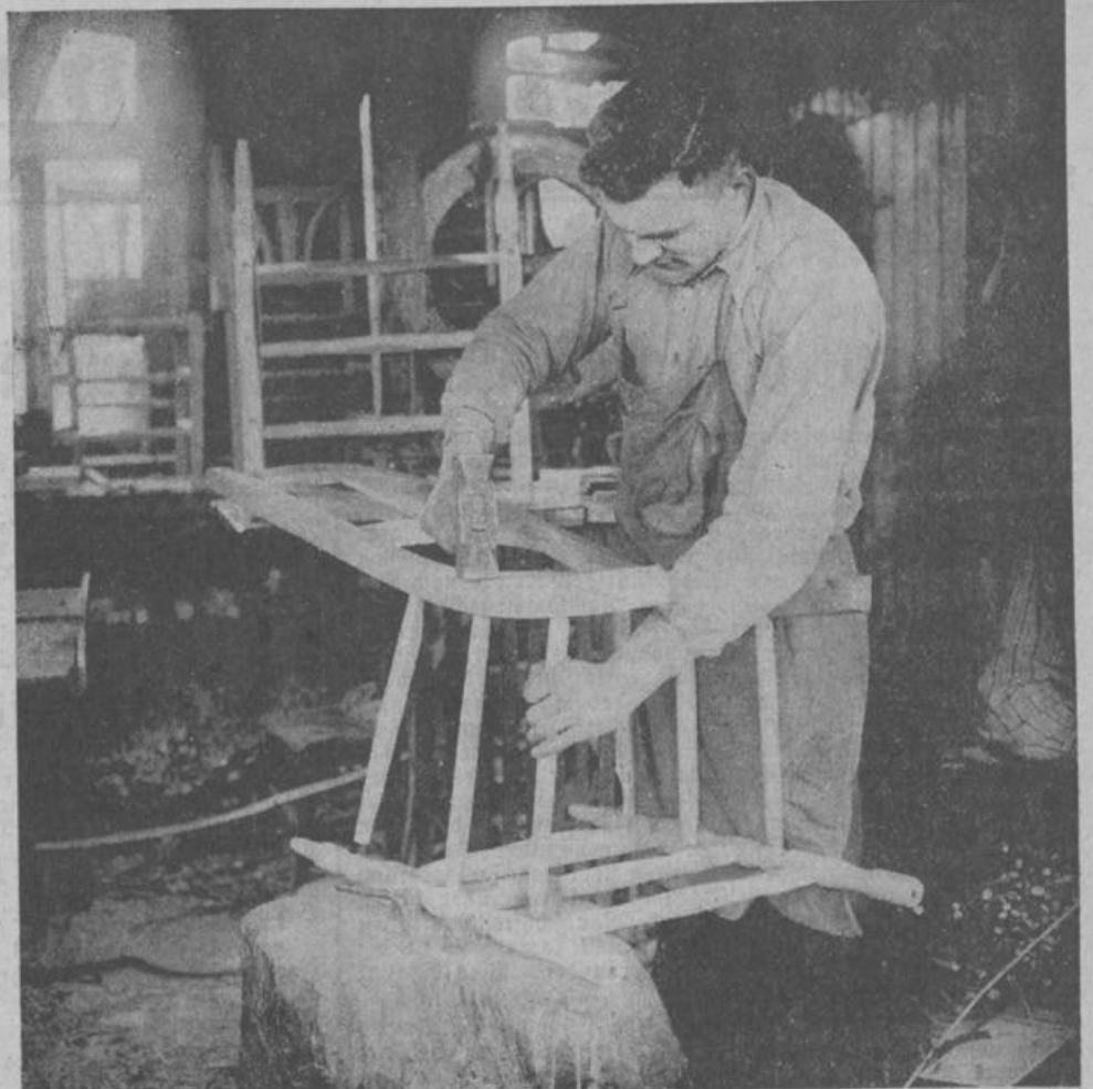
Auf einem grohen Holzblock werden die einzelnen Teile des Stuhles, nachdem sie auf der Drehbank die althergebrachten Formen erhalten haben, zusammengefügt.
