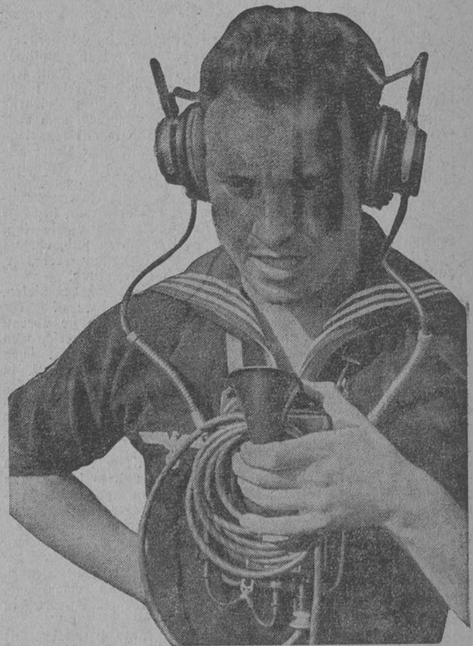
Der Telephonist am Geschütz erhält von der Auswert- stelle fortlaufend die Schießwerte, nach denen die Rich- tanoniere Grob- und Feineinstellung vornehmen.
