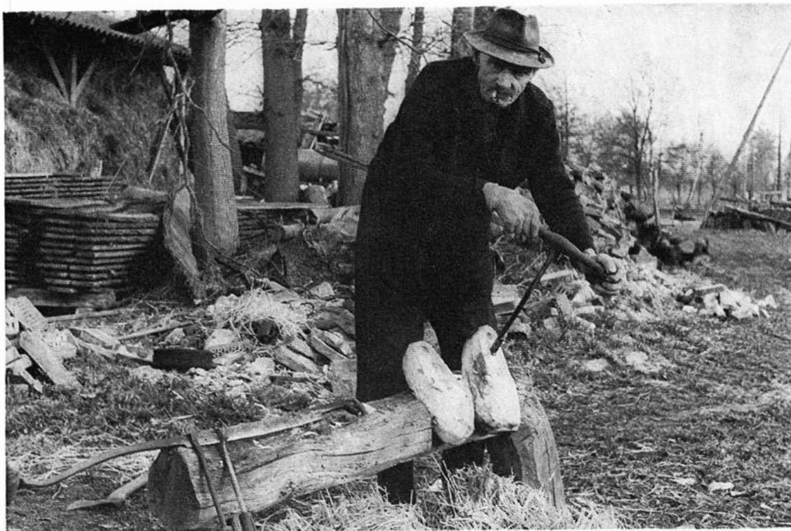
*Die Purren sind im Ausschnitt des Holzbocks festgekeilt — das Ausbohren beginnt. Mit dem Rüetmesser wird der Holzschuh von innen fein ausgearbeitet.*
