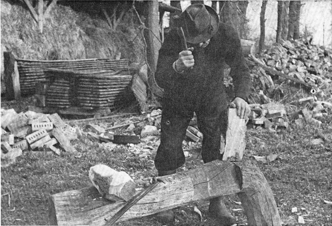
*Die Bilder zeigen das Handwerkszeug und den Vorgang des Holzschuhmachens. Mit dem Beil wird der abgesägte „Purren“ roh behauen.*
