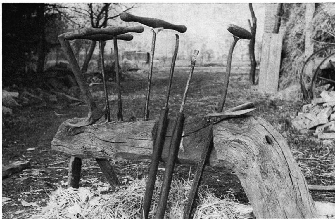
*Das Holzschuhmachergerät: Däi Holskebeck, (von links nach rechts) däi Düßel, 3 Läpelbohrs, 2 Rüetmesser, dat Tochmest und däi Bielen.
