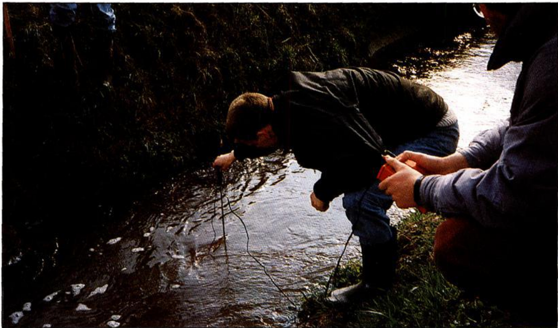
Bild 1: Bestimmung der Fließgeschwindigkeit an der Landriede mit einem hydrometrischen Meßflügel.
