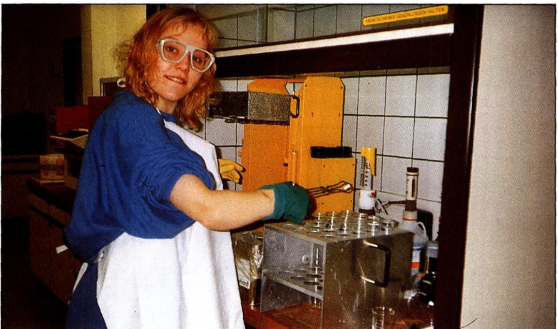
Bild 2: Vorbereitung von Proben für die Stickstoffbestimmung im ISPA-Labor. Nach Zugabe von Schwefelsäure und Katalysator-tablette (im Bild) werden die Proben 2 Stunden bei 360°C aufgeschlossen. In der Aufschlußlösung wird der Stickstoffgehalt halbautomatisch bestimmt.
