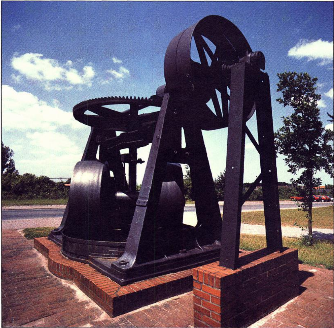
Der Kollergang, ein Relikt der Dampfziegelei Wilberding, des ersten Steinfelder Industriebetriebes.
