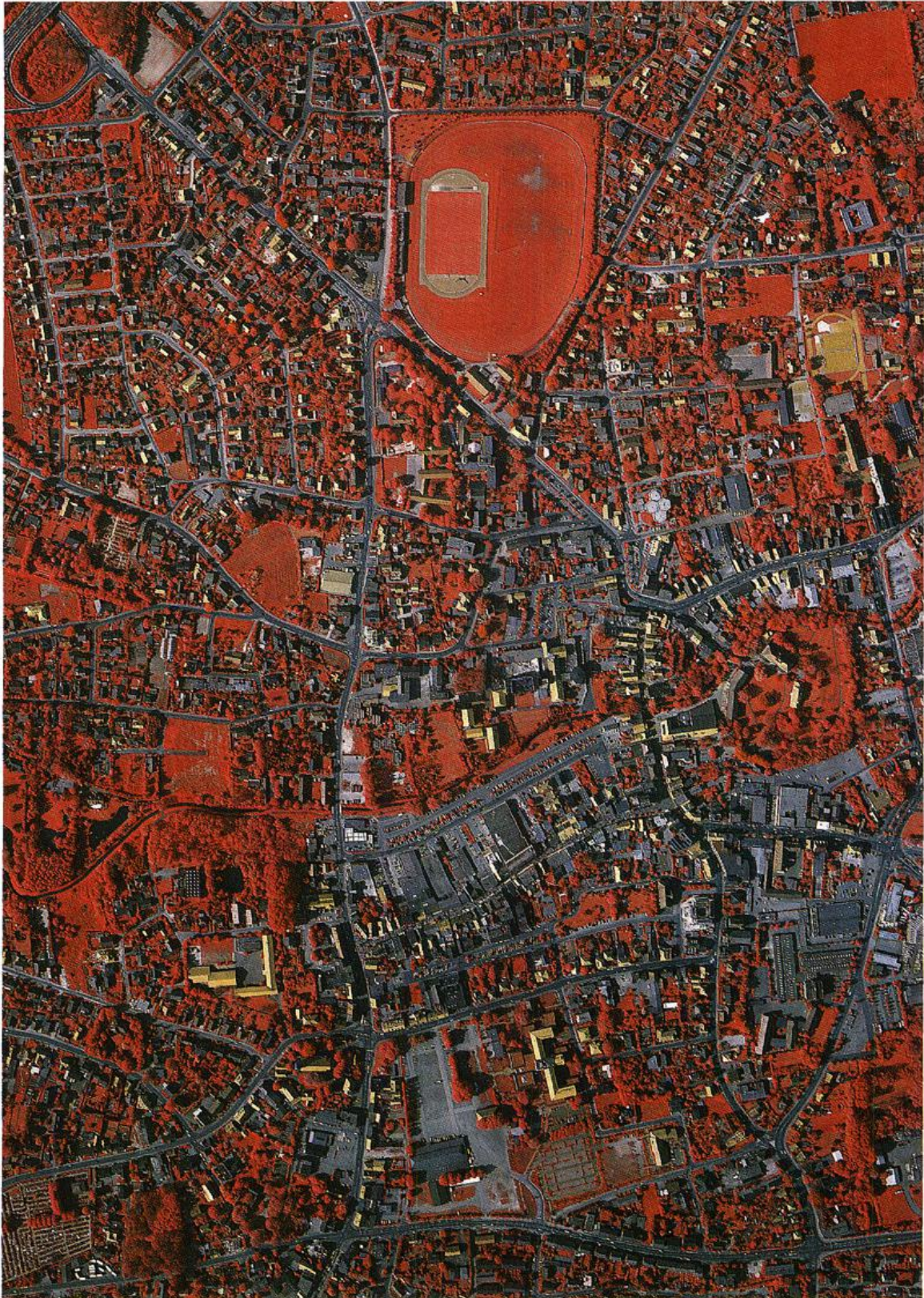
Stadt Cloppenburg - Color-Infrarot-Luftbild (CIR), Maßstab 1:10.000, Aufnahmehöhe ca. 3.000 m, Aufnahmedatum 15.05.1992; Auftraggeber: Ldkr. Cloppenburg
