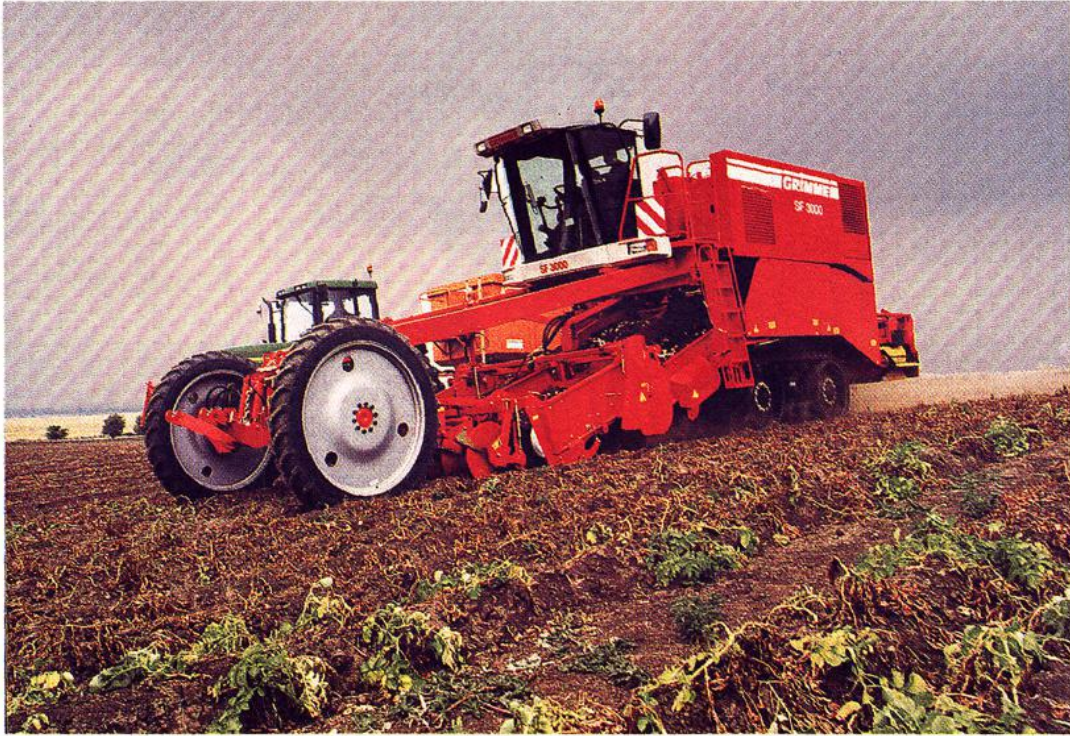
SF 3000: Vierreihige selbstfahrende Überlademaschine mit 326 PS Mercedes-Benz-Motor, mit Raupenfahrwerk
