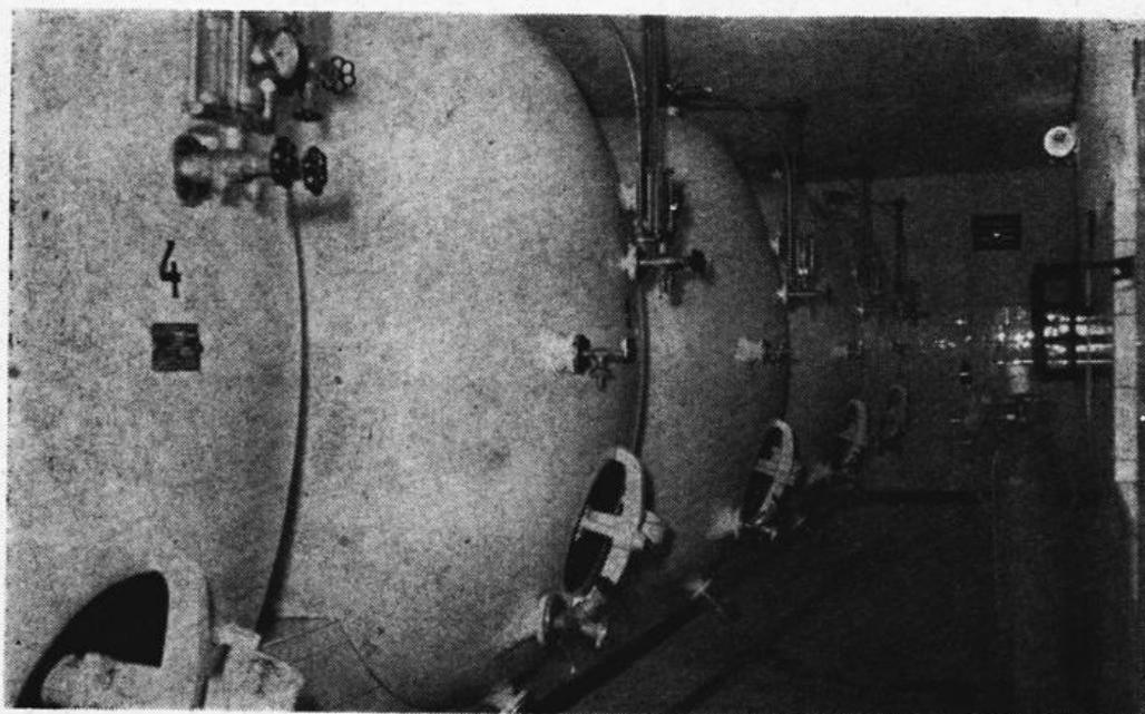
Teilansicht des Lagerkellers, in welchem Apfelsaft nach dem neuesten Verfahren unter Kohlensäure-Druck gelagert wird.
