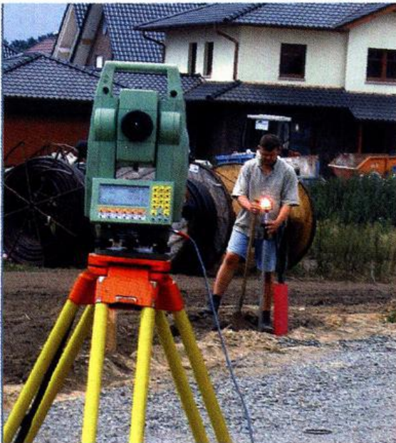
Abb. 5: Vermessung mit Tachymeter
