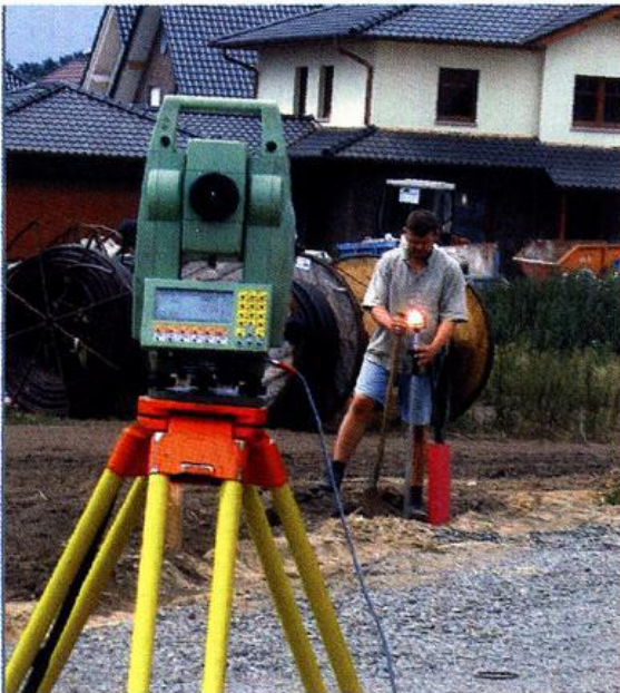
Abb. 5: Vermessung mit Tachymeter
