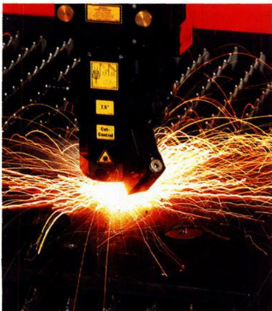
High-tech Laserschneidanlage mit 4400 Watt zum Schneiden von Blechen bis zu 25 mm
