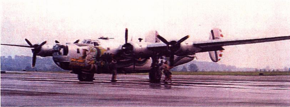
Abb. 2: Der viermotorige amerikanische Bomber B 24 „Liberator“ hatte eine Länge von 20,54 m. Er war mit 10 Maschinengewehrständen bestückt, konnte bis zu 5800 kg Bomben tragen und rund 3700 km weit fliegen.
