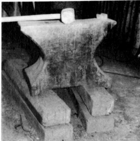
Abb. 3 und 4: Vierkantamboß und Sperrhorn aus der ehemaligen Spatenschmiede Blömer (heute Römbke) in Telbrake bei Vechta.
