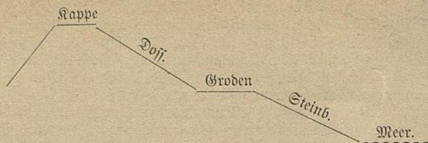
Seedeiche gehen allmählich in die Flußdeiche über. Deiche, welche hart am Wasser liegen, heißen Gefahrdeiche; diejenigen, welche durch weiter hinausgebaute überflüssig werden, Schlummerdeiche. Der Bareler Deich, auf welchem der Leuchtturm steht, wird jetzt abgetragen. Beschädigungen der Deiche müssen rasch ausgebessert werden, sonst erfolgt ein Deichbruch. Die Gesetze über Anlage und Verbesserung der Deiche bilden die Deichordnung, das Deichrecht.
