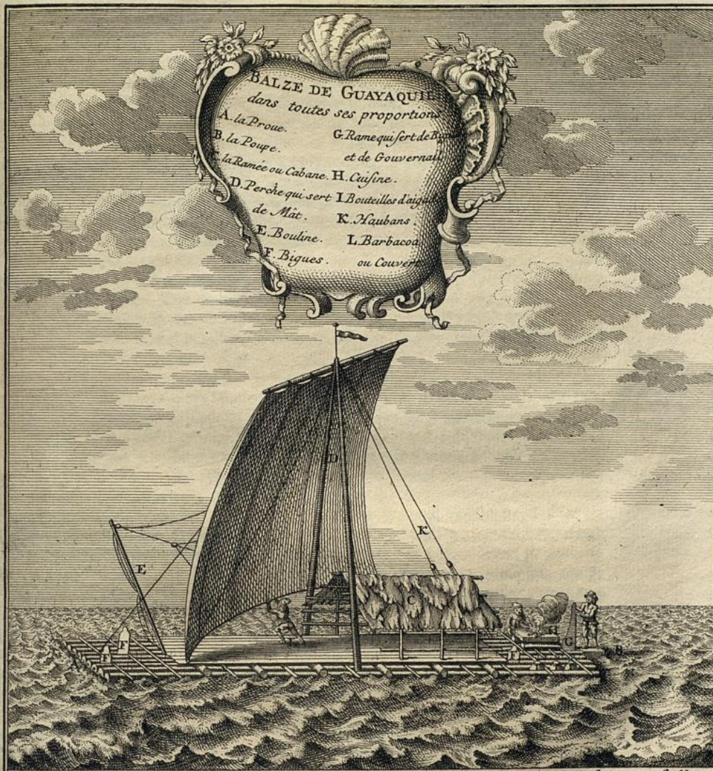
BALSA oder FAHRZEUG VON GUAYAQUIL mit seinen Verhaeltnissen vorgestellt. A. Das Vordertheil. E. Segelleinen. H. Die Küche. B. Das Hintertheil. F. Schutzhoelker. I. Wasserflaschen. C. Die Laube oder Huette. G. Ruder, welches zum Schutzholze K. Haupttauen oder die Wand. D. Stangen, welche statt des Mastes dienen und Steuerruder dienen. L. Der Boden oder das Bedeck.
