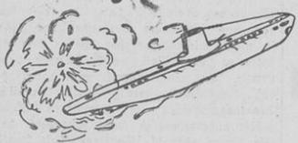
Die Wasserbombe, schon im Weltkrieg 1914-18 als Kampfmittel gegen U-Boote entwickelt, ist ein Sprengkörper, der mit Hilfe einer Abrollbahn oder eines Werfers gegen das getauchte U-Boot eingesetzt wird und in einer vorher eingestellten Tiefe explodiert.
