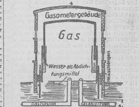
Schematischer Schnitt durch einen Gasbehälter. Der teleskopartige Behälter wird durch das Gas nach oben gedrückt, wobei der luftdichte Abschluß unten durch Wasser erzielt wird. Bei dem Aufsteigen in der Seltenertrage ist wahrscheinlich aus dem undichten Behälter Gas entwichen, das mit der Luft in dem Gehäuse zwischen dessen Wänden und dem Gasometer ein explosives Gemisch bildete, sich entzündete und bei der heftigen Verbrennung den Gasometer zertrümmerte.
